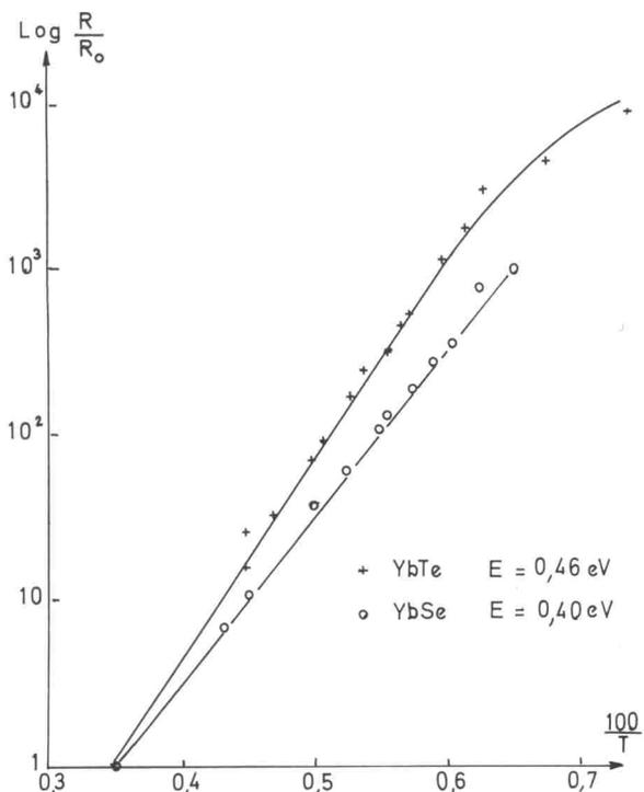
FIG. 4. — Variation de  $\log R/R_0$  en fonction de l'inverse de la température pour YbSe et YbTe.
